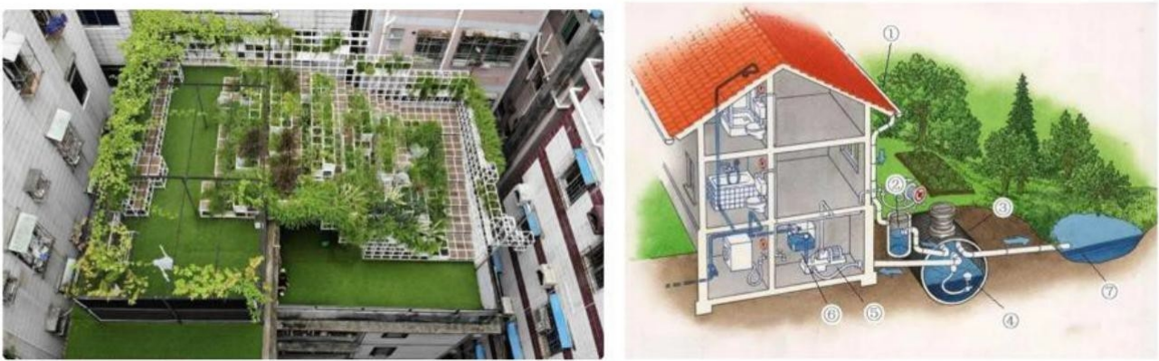
图 11.3.1-2 建筑与小区低影响开发雨水系统示意图
